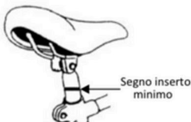
Per regolare l'altezza della sella, inserire il tubo reggisella nel tubo del telaio. Quando la sella è posizionata all'altezza desiderata, serrare la leva o la vite di fissaggio.
