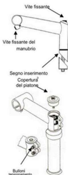
**PIANTONE CONVENTIONALE:** Allentare la vite di fissaggio per sbloccare l'anello conico. Regolare l'altezza desiderata e serrare la vite.
